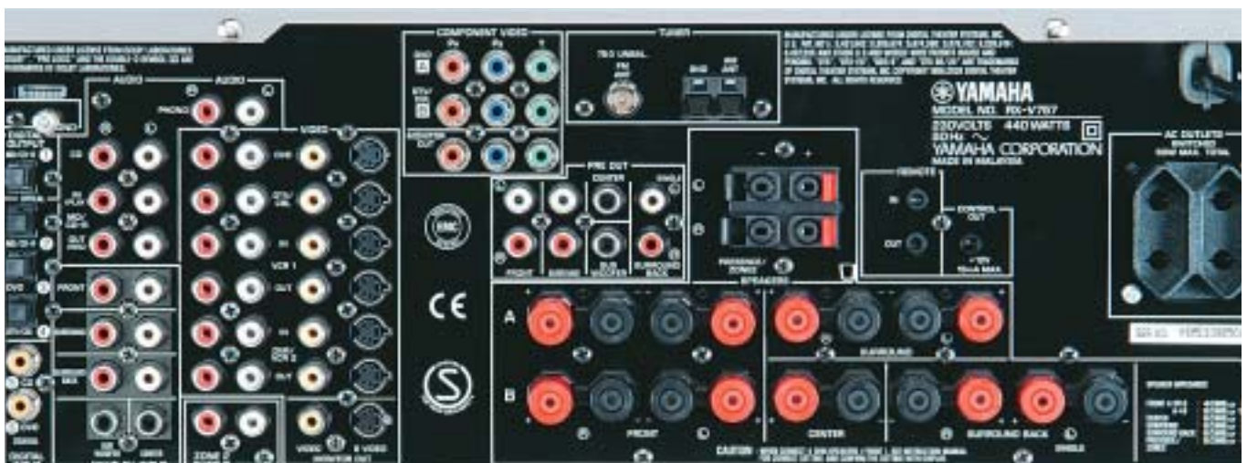
Dvě dvojice drobnějších přítlačných konektorů patří horním předním efektům. Presence efekt získáme výměnou za zadní center, ostatní kanály mají masivní šroubovací svorky.
