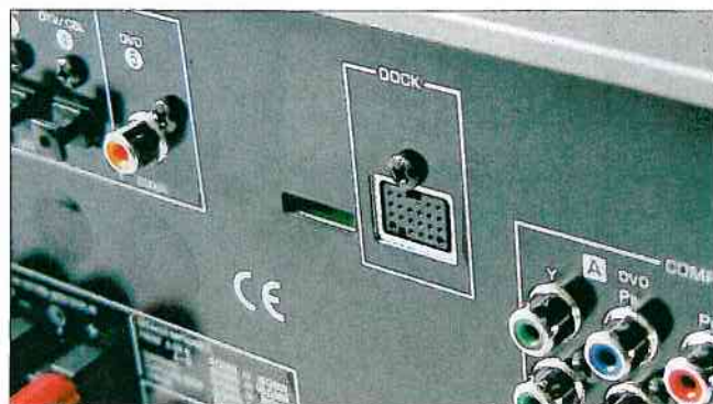
Dock-Tor: Die Multipinbuchse für das optionale iPod-Interface nimmt Audiodaten entgegen und gibt Steuerbefehle aus.
