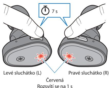
**3 Po vypnutí podržte funkční tlačítko a tlačítko + (plus) po dobu 10 sekund.**
